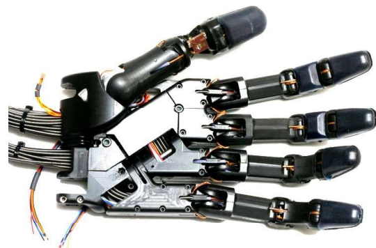
Fig. 1. Ejemplo de una prótesis biónica controlada mediante una plataforma embedded (Arduino Uno).
