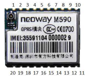
Figura 5. Fotografía del módulo GSM M590 de Neoway.
