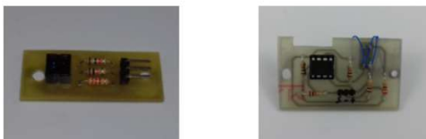
Fig 8. PCB de adaptación de los sensores CNY70 y TCST1103 diseñados
