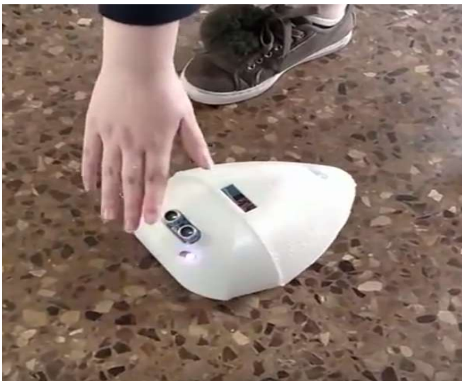
Fig. 6. Uno de los Proyectos Exprés en su edición “Risa”, integrado en la maqueta y funcional. Es un pequeño robot que reacciona a la presencia y la distancia, huyendo según ciertos criterios y reaccionando así mismo cuando se le despegan del suelo.
