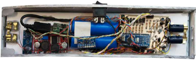
Fig. 5. Prototipo de uno de los Proyectos Exprés, completamente integrado en la maqueta y funcional. Se trata de un objeto que dos personas tienen que sujetar con los dientes por cada uno de sus extremos. Detecta desequilibrio y genera sonidos de recompensa y castigo. En otros proyectos el castigo era una pequeña descarga eléctrica, una vibración, etc.
