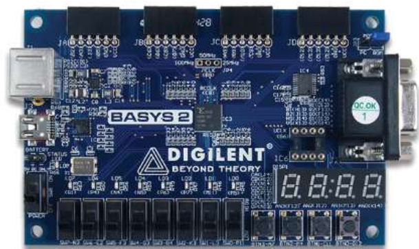
Fig. 1. Placa de desarrollo Basys 2 de Digilent utilizada en el bloque de diseño con circuitos lógicos programables de la asignatura.
