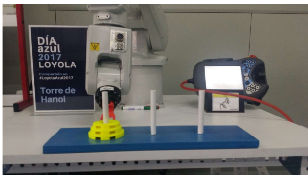
Fig. 6. Montaje de las torres de Hanoi.
