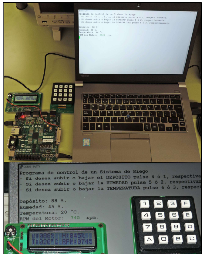
Fig. 2. Implementación del sistema de riego con MicroBlaze.
