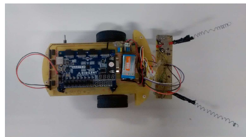
Fig. 2. Foto donde se muestra el movil utilizado para la implementacions de la hormiga para que salga del laberinto
