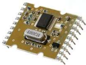
Figura 9. Módulo de Radio-Frecuencia utilizado para el desarrollo de la aplicación, FM-RXQ1-433RF.
