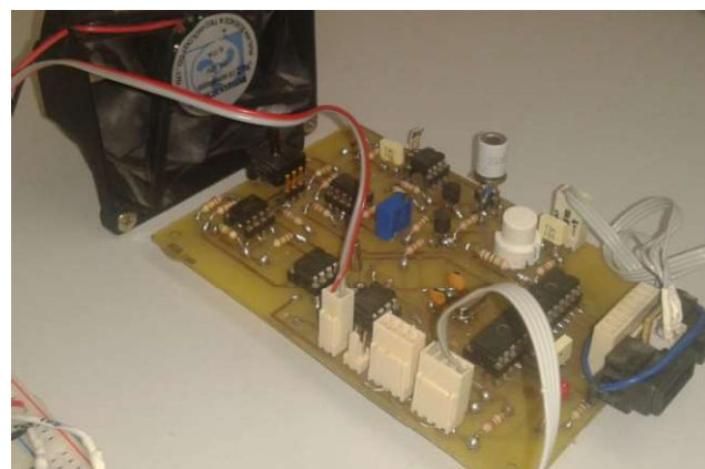
Figura 2. Prototipo de placa PCB con los diferentes sensores y actuadores que conforman la aplicación.
