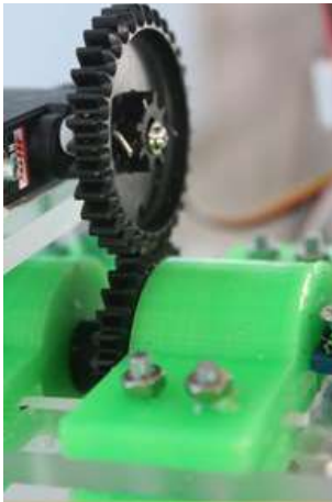
Figura 10. Detalle del sistema de giro del soporte de la pinza en el brazo articulado (movimiento muñeca). La imagen muestra los dos engranajes solidarios al servomotor y al eje.
