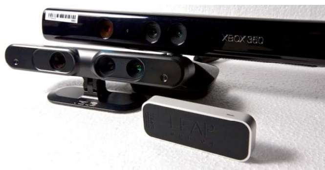
Figura 1. Varios ejemplos de dispositivos comerciales para desarrollar un control por reconocimiento de gestos. Microsoft Kinect, Asus Xtion Sensor y Leap Motion.
