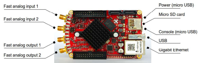
Figura 1. Red Pitaya, con la localización de sus elementos fundamentales.
