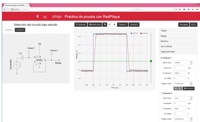
Figura 9. Interfaz web de la práctica remota en el que podemos ver el estudio de la slew-rate del seguidor.
