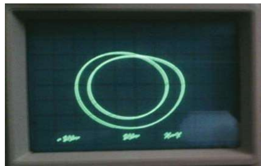
Figura 9. Resultado experimental, atractor para un valor de R_A = 1550 \Omega o A = 0,65 , periodo-4.
