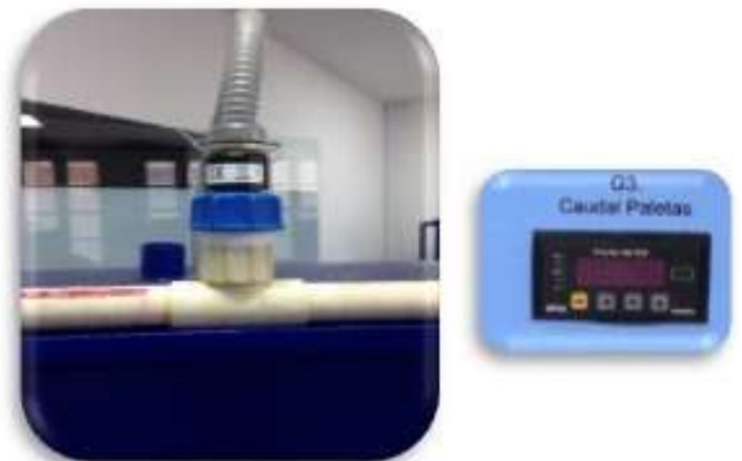
Fig. 7. Sensor de paletas rotativas con indicador
