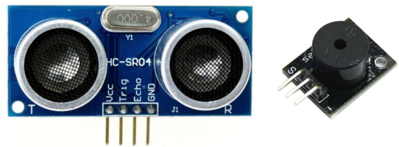
Figura 6. Componentes principales utilizados en la Práctica 1 (módulo de ultrasonidos HC-SR04 y 'buzzer' activo).
