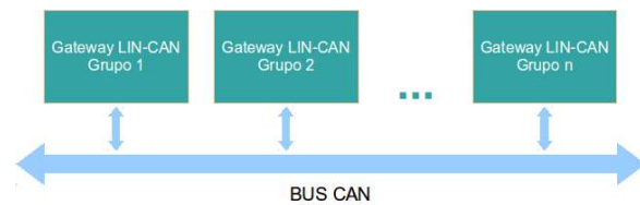
Figura 9. Esquema global de la conexión a través de bus CAN de los 'gateways' desarrollados por cada grupo de alumnos.
