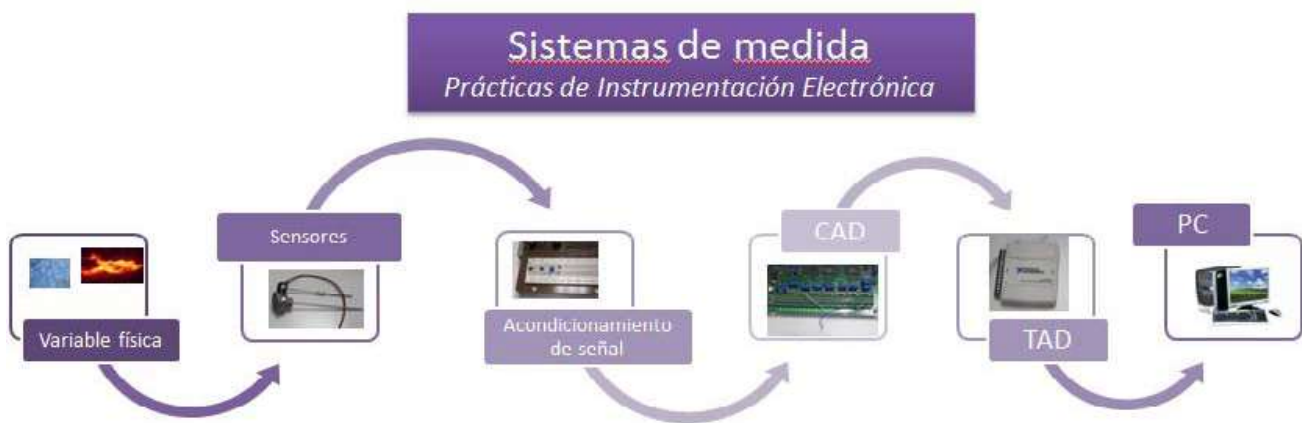
Fig. 1. Esquema de los elementos que intervienen en un sistema de medida
