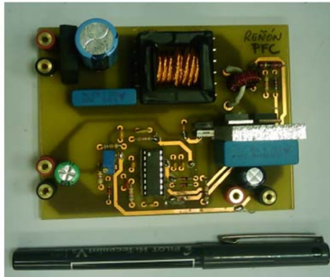
Figura 4. Prototipo experimental de la fuente de alimentación conmutada diseñada y construida por cada alumno de la asignatura.
