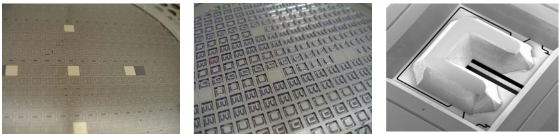
Figura 5. Anverso y reverso de un sustrato terminado. Detalle del dorso.
