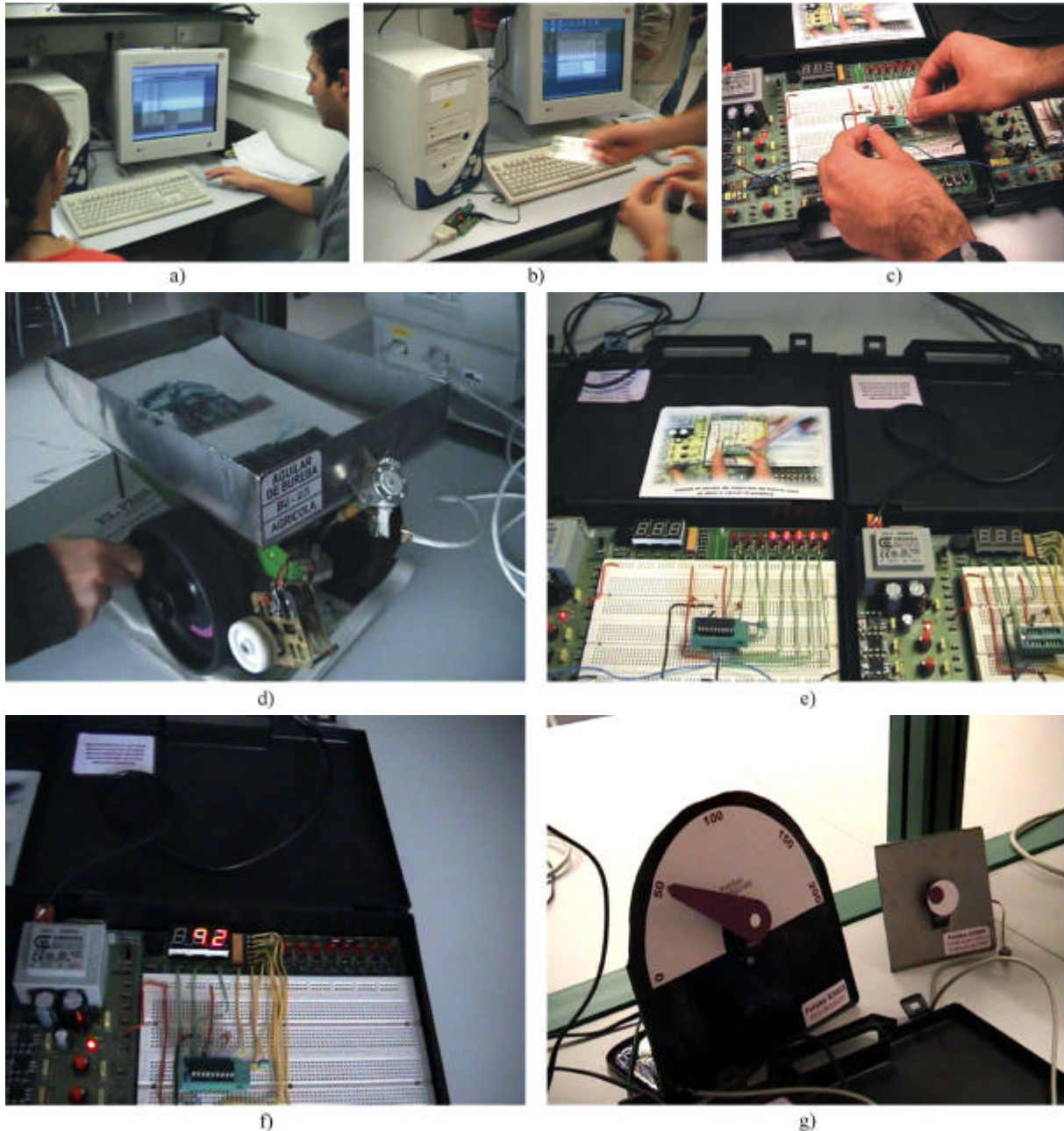
Figura 1: a) Los alumnos en grupos de dos desarrollan el código de la prueba. b) Puesto de grabación con grabador SCHAER. c) Los alumnos insertan el microcontrolador en el circuito. d) Los alumnos accionan la manivela que hace girar el eje. e) Prueba de contarrevoluciones en versión VISUAL f) Prueba del contarrevoluciones en versión PRECISA. g) Prueba de contarrevoluciones en versión CLÁSICA.
