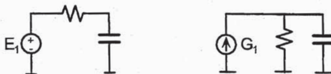
Figura 5.- Circuitos sencillos para la obtención de polos en la función de transferencia de los modelos propuestos.
